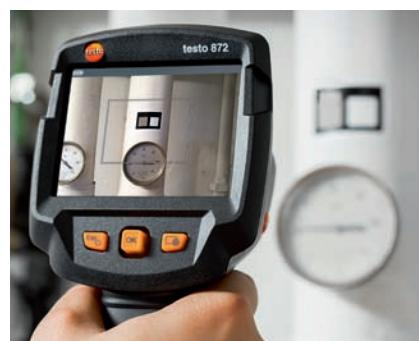
Просто прикрепите к объекту измерения один из эталонных стикеров ( $\epsilon$ -маркеров), входящих в комплект поставки. Тепловизор распознает стикер с помощью встроенной цифровой камеры, определит коэффициент излучения и отраженную температуру, а затем автоматически выставит оба значения.
